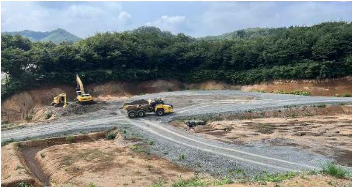
[Der knickgelenkte Muldenkipper HM400 arbeitet während der Testphase autonom]
