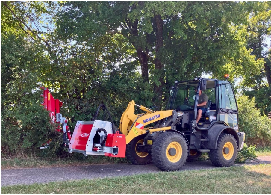
Bild 2: Die Kombination aus Radlader und Astschere macht den Bauhof flexibel – ob Transport, Schnitt oder Verladung: alles mit nur einem Fahrzeug.
