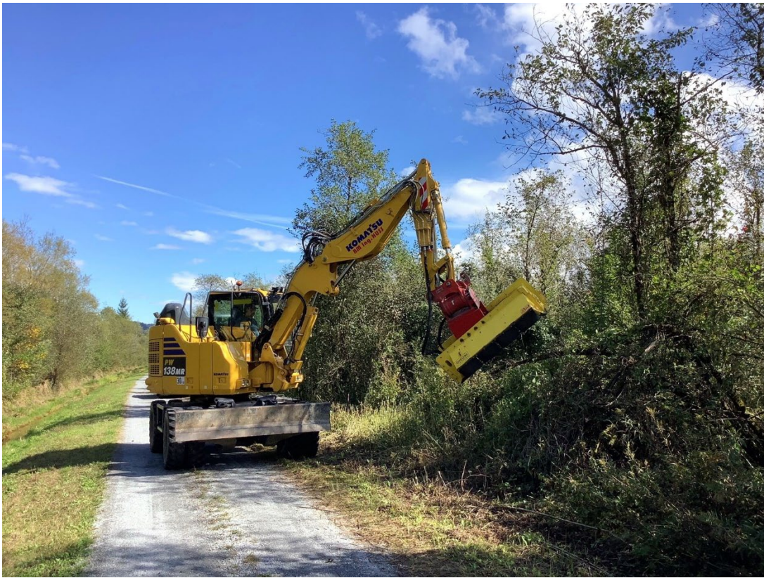
Der Kompaktmobilbagger PW138MR-11 von Komatsu beim Einsatz mit dem hydraulischen Mulcher.
