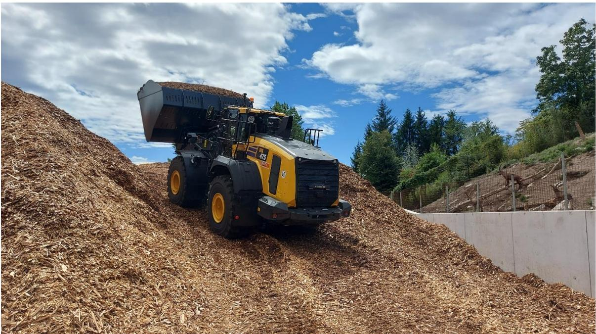
Der Radlader WA475-10E0 von Komatsu wurde für den Einsatz im Biomasse-Heizkraftwerk der Salzburg AG in Siezenheim mit einer speziellen Schaufel ausgestattet, die ein hohes Transportvolumen möglich macht.
