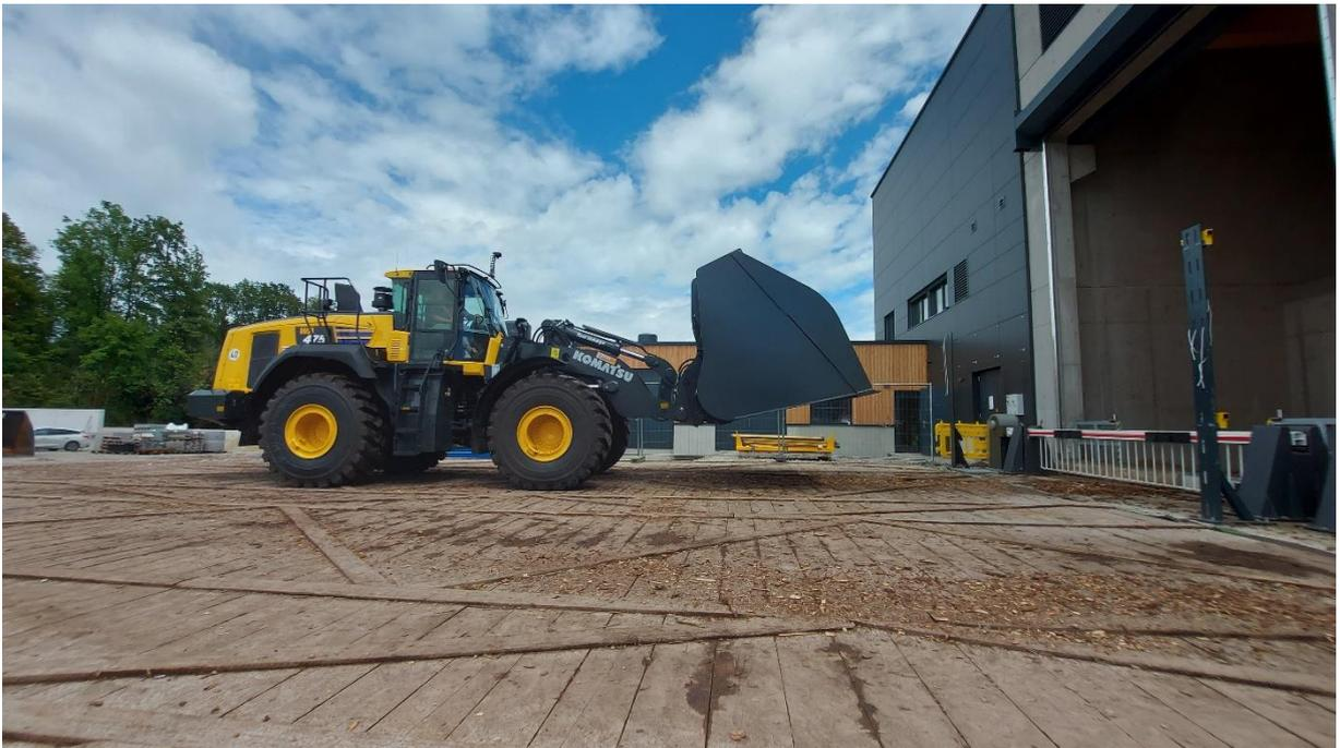
Der WA475-10E0 ist mit mehreren Kameras ausgestattet, die es dem Fahrer über seinen Monitor erlauben, zu sehen was links und rechts neben ihm als auch hinter seinem Arbeitsgerät passiert.
