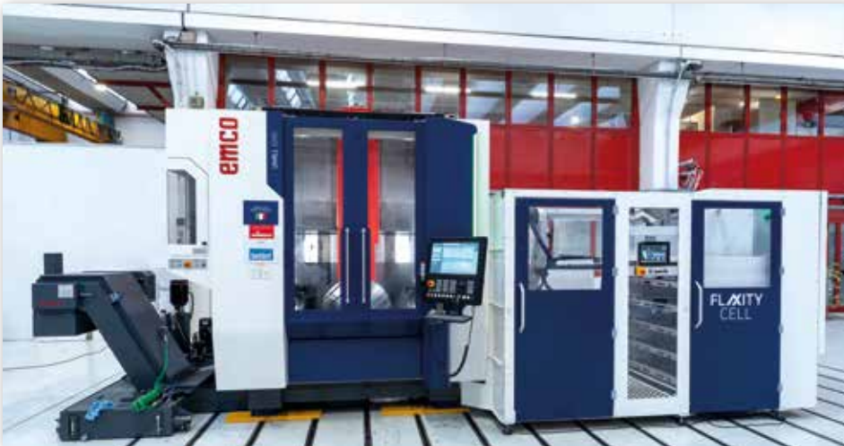
Universalfräsmaschine Umill 1000 von EMCO: 5-Achs-Simultanbearbeitung in Portalbauweise.
