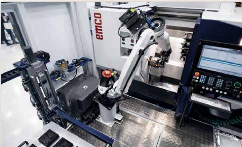
Emco Universalturn 50: Die kompakte Universal-Drehmaschine für präzise und wirtschaftliche Zerspanung ist ausgelegt auf hohe Prozessstabilität, einfache Bedienung und flexible Einsatzmöglichkeiten in Ausbildung und Fertigung.
