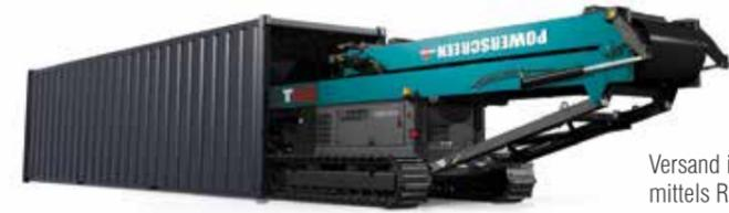
Versand im Container. Verladen/Ausladen mittels Raupenfahrwerk. Kein Kran erforderlich.
