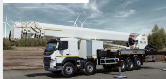
Ein technisch einwandfreier Zustand ist bei Windkraftanlagen sehr wichtig. Um Mängel rechtzeitig zu erkennen, muss die Anlage regelmäßig optisch und auf Geräusentwicklung überprüft werden. Hier sind Hubarbeitsbühnen ideal geeignet, um Arbeitszeiten zu verkürzen, die optimale Arbeitsposition zu ermöglichen und sicheres Arbeiten zu gewährleisten.
