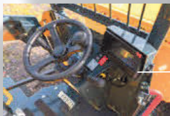
Nach IP67 geschützter 7" LCD Monitor
