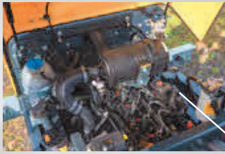
Servicezugang über abschließbare Motorhaube
