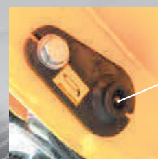
Parkbremse federbetätigt, hydraulisch gelöst. Kein Einstellen erforderlich.
