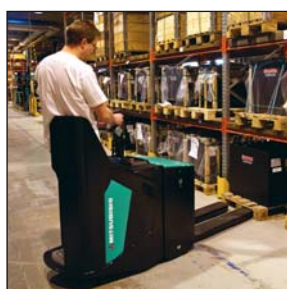
Plattform-Modell mit feststehendem, seitlichen Schutz (PBF25N)
