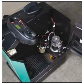
Fahreplatz ausschwingbar für maximalen Service Zugang
