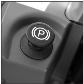
Ideal – betätigen der automatischen Handbremse per Knopf
