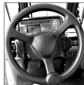
Komplett hydrostatische Lenkung
