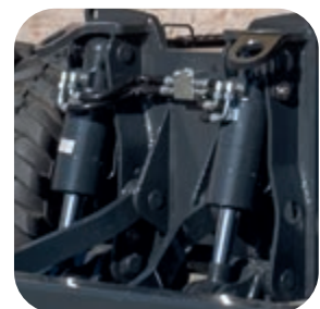
Schild-/Pratzenzylinder mit integriertem Rückschlagventil (Standard)
