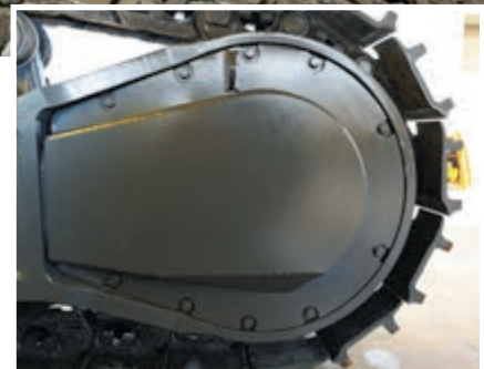
Robuster Schutz der Fahrmotoren
