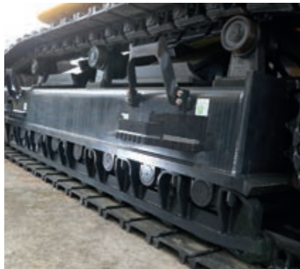
Laufrollenschutz über die gesamte Laufwerkslänge (Option)
