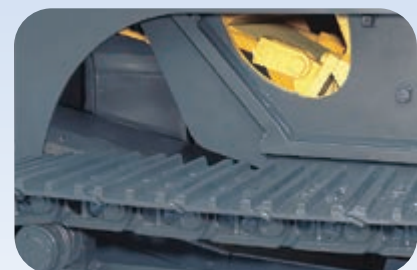
Zugangsöffnungen an der Brechwerkseite (beidseitig am Unterwagen)
