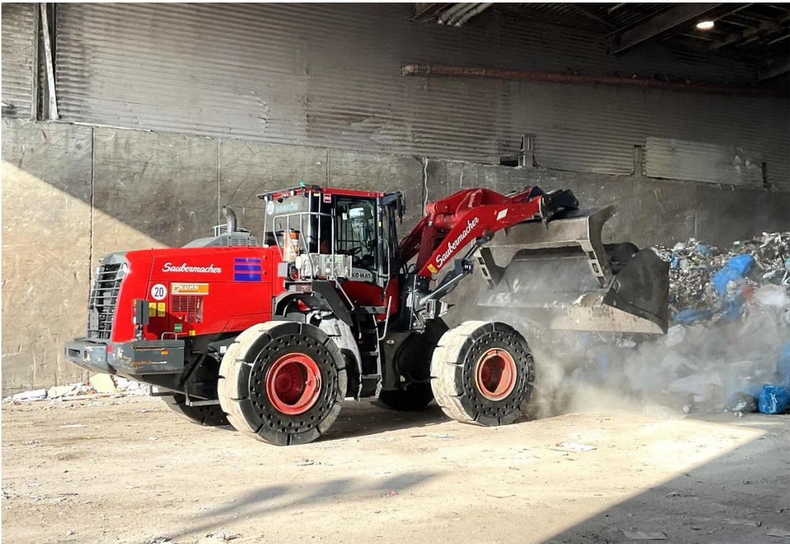
Der WA380-8E0 für Saubermacher wurde zudem mit Vollelastikreifen und einem Schnellwechsler mit Hochkippschaufel ausgestattet.
