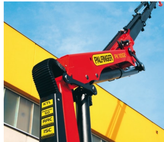
15° überstreckbarer Knickarm (Power Link Plus) bei Kranmodellen der 8 bis 100 Meter-tonnenklasse
