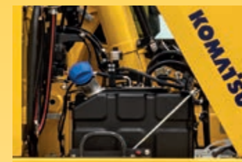
Einfacher Zugang zum AdBlue®-Tank
