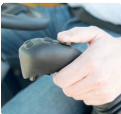
Ergonomische Joysticks mit Proportionalsteuerung
