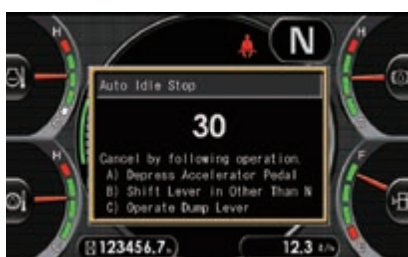
Einstellbare, automatische Leerlaufabschaltung
