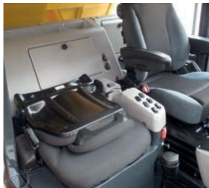
Der vollwertige Beifahrersitz lässt sich wegklappen und ist mit einem 2-Punkt-Sicherheitsgurt ausgestattet.
