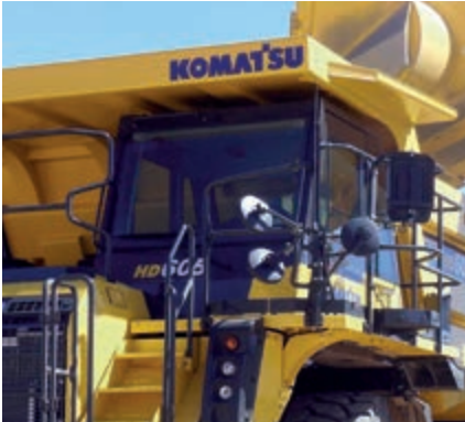
ROPS/FOPS nach ISO 3471 ROPS und ISO 3449 FOPS Stufe II serienmäßig
