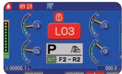
Monitorsystem mit Selbstdiagnosefunktion
